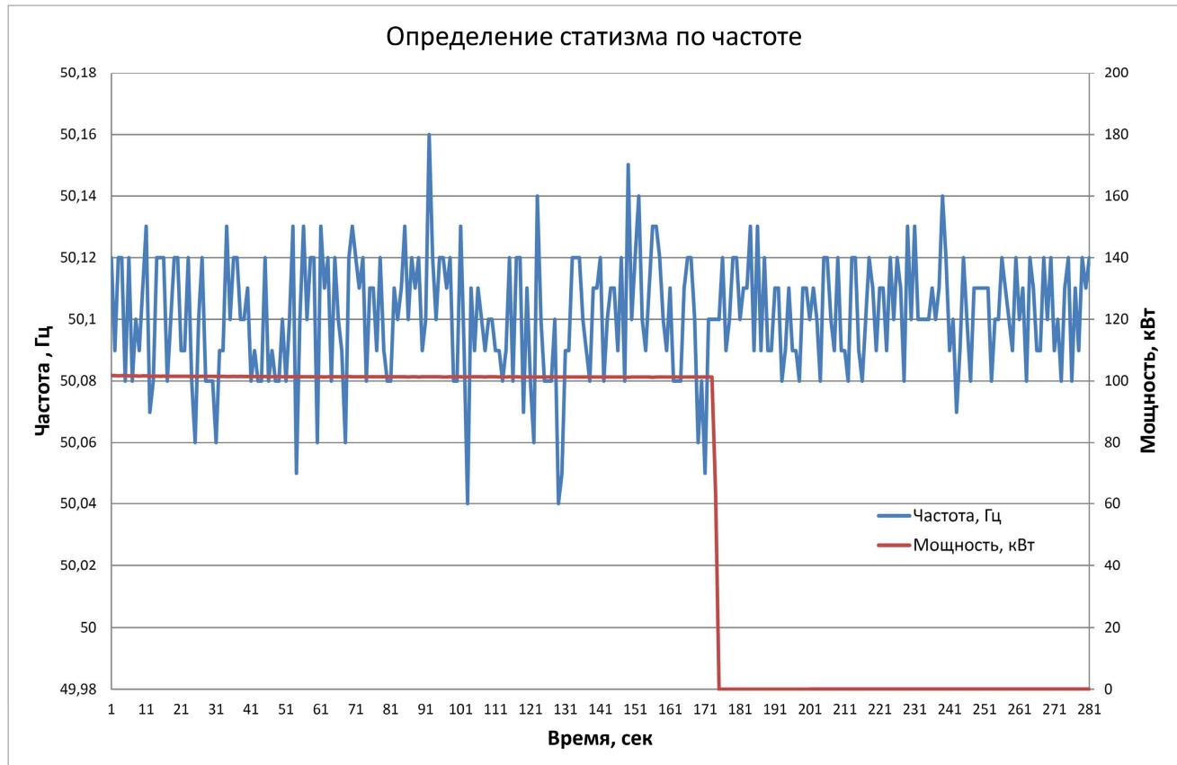
В данном случае имеем:  $f_{i,r} = 50,11 \text{ Гц}$ ,  $f_r = 50,0 \text{ Гц}$ , отсюда получаем  $\delta f_{st} = 0,22\%$
