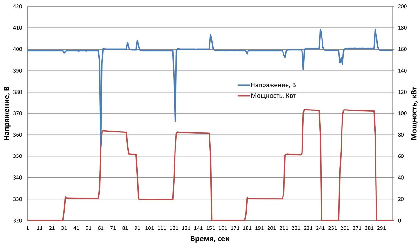
В данном случае мы имеем,  $U_{dyn,min} = 352,2\text{ В}$ ,  $U_{dyn,max} = 409,3\text{ В}$ ,  $U_r=400,0$  В, отсюда получаем  $\delta U_{dyn}^- = -11,95\%$ ,  $\delta U_{dyn}^+ = +2,33\%$ .
