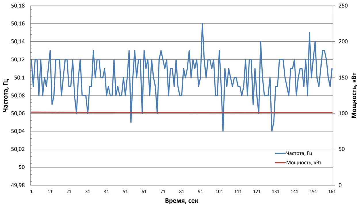
В данном случае мы имеем,  $f_{max} = 50,16$  Гц,  $f_{min} = 50,04$  Гц,  $f_r=50,0$  Гц, отсюда получаем  $\delta f_y = 0,12\%$ .
