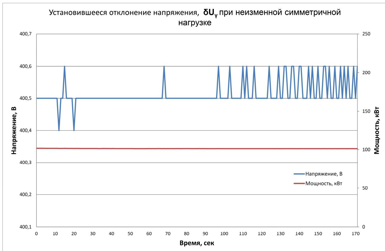
В данном случае мы имеем,  $U_{max} = 400,6$  В,  $U_{min} = 400,4$  В,  $U_r = 400,0$  В, отсюда получаем  $\delta U_y = 0,025\%$ .
