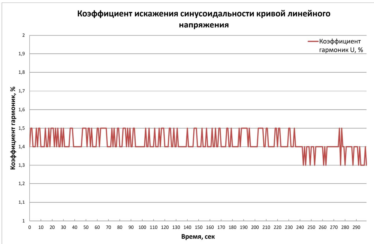
Коэффициент искажения синусоидальности кривой напряжения измеряется в режиме Х.Х. Из приведенного графика имеем  $U_{\text{thd}}=1,5\%$ .
