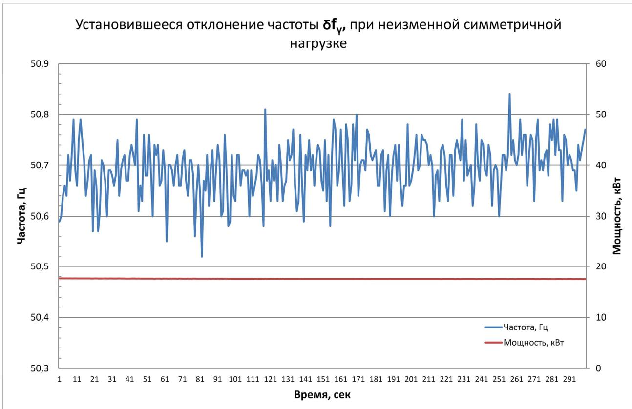
В данном случае мы имеем,  $f_{max} = 50,52$  Гц,  $f_{min} = 50,84$  Гц,  $f_r = 50,0$  Гц, отсюда получаем  $\delta f_y = 0,32\%$ .
