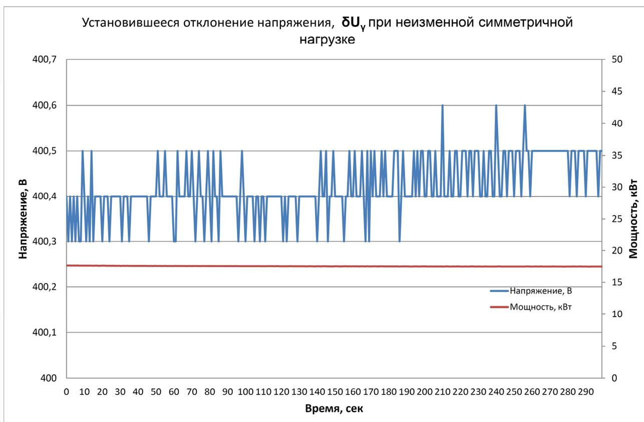
В данном случае мы имеем,  $U_{max} = 400,6\text{В}$ ,  $U_{min} = 400,3\text{В}$ ,  $U_r = 400,0\text{ В}$ , отсюда получаем  $\delta U_y = 0,04\%$ .
