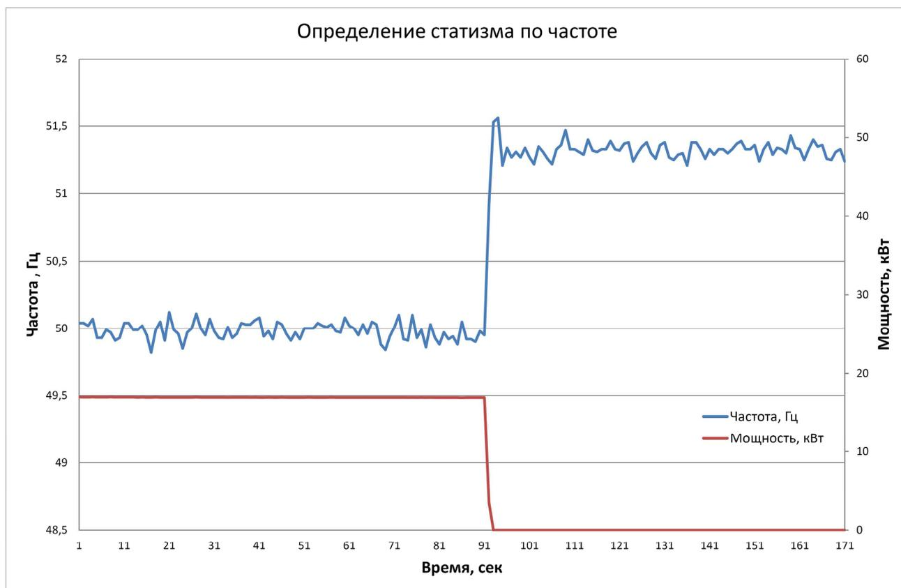
В данном случае имеем:  $f_{i,r} = 51,32$  Гц,  $f_r = 50,0$  Гц, отсюда получаем  $\delta f_{st} = 2,64\%$
