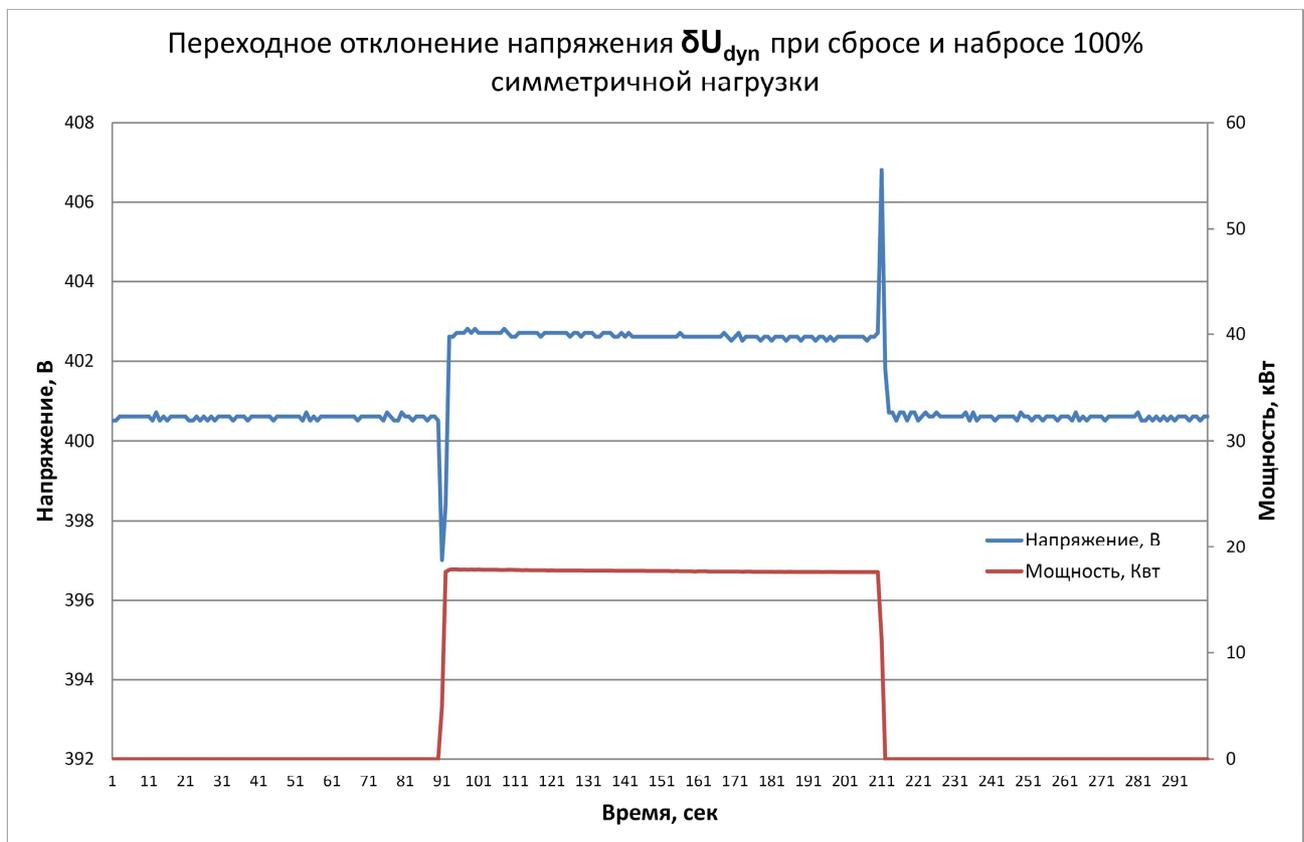
В данном случае мы имеем,  $U_{dyn,min} = 397,0\text{В}$ ,  $U_{dyn,max} = 406,8\text{В}$ ,  $U_r = 400,0\text{ В}$ , отсюда получаем  $\delta U_{dyn}^- = -0,75\%$ ,  $\delta U_{dyn}^+ = +1,7\%$ .
