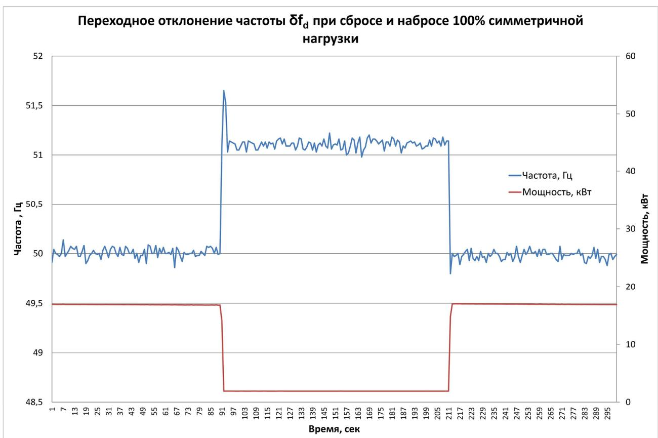
**Пункт 5.** Время восстановления частоты при набросе 100% симметричной нагрузки.
