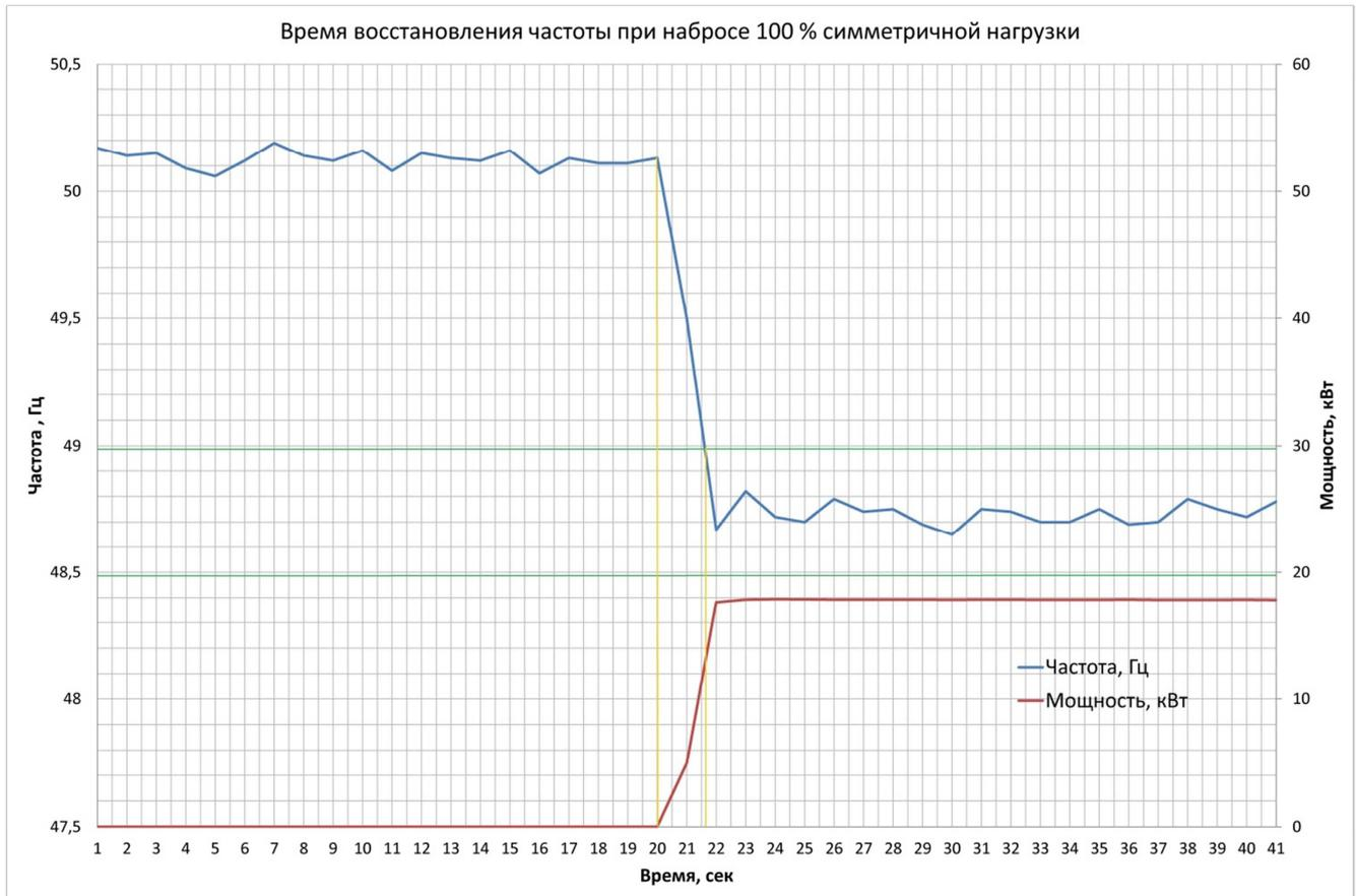
В данном случае имеем: зона допустимых значений установившегося значения частоты  $\pm 0,5\%$  от частоты фактической мощности  $f_{arb} = 48,72,0$  равна  $48,48 \div 48,96$  Гц, из графика находим  $t_{f,in} = 1,6$  сек.
