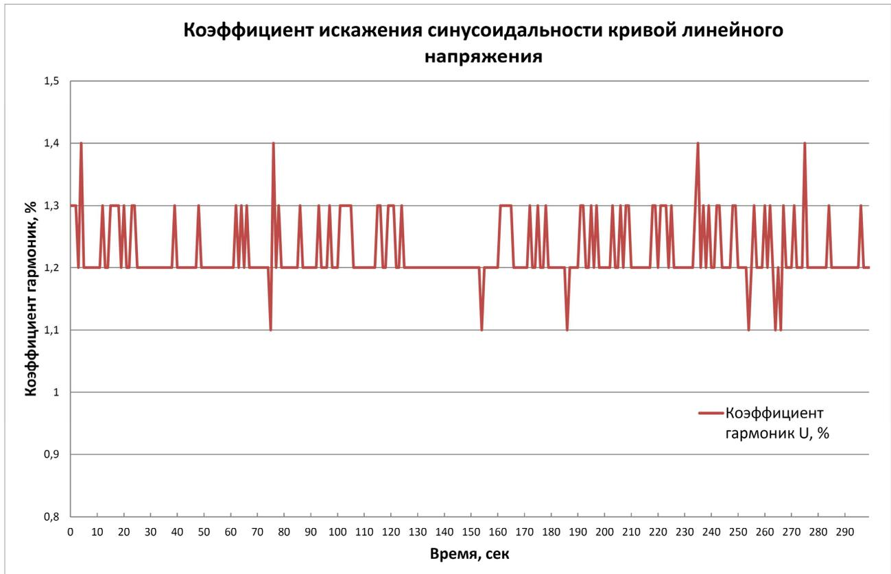
Коэффициент искажения синусоидальности кривой напряжения измеряется в режиме Х.Х. Из приведенного графика имеем  $U_{thd} = 1,4\%$ .
