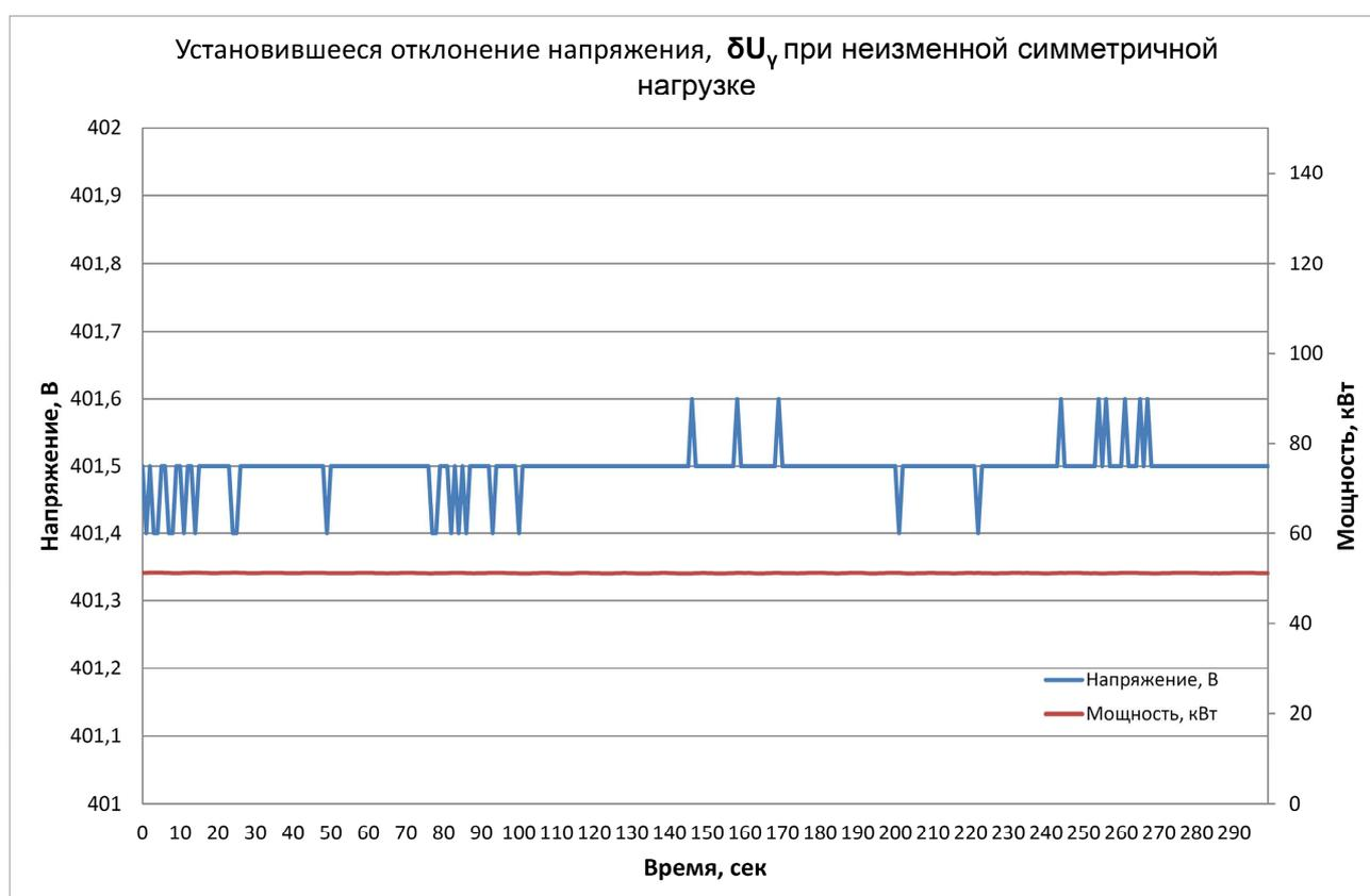
В данном случае мы имеем,  $U_{max} = 401,6\text{В}$ ,  $U_{min} = 401,4\text{В}$ ,  $U_r = 400,0\text{ В}$ , отсюда получаем  $\delta U_y = 0,025\%$ .
