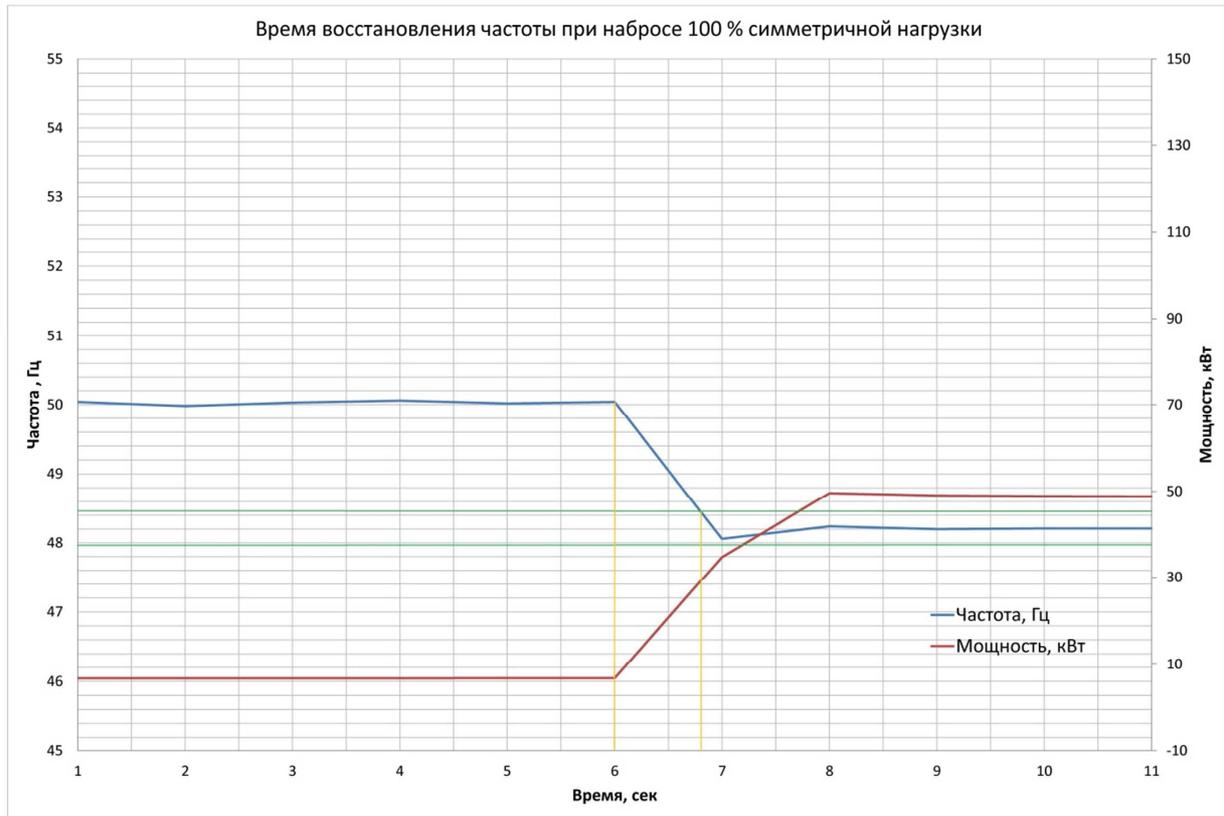
В данном случае имеем: зона допустимых значений установившегося значения частоты  $\pm 0,5\%$  от частоты фактической мощности  $f_{arb}=48,21$  равна  $47,97 \div 48,45$  Гц, из графика находим  $t_{f,in} = 0,8$  сек.
