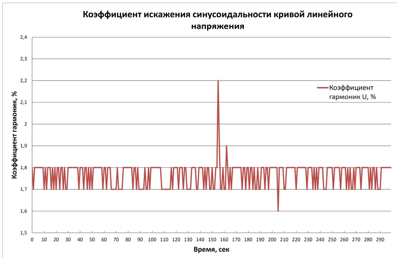
Коэффициент искажения синусоидальности кривой напряжения измеряется в режиме Х.Х. Из приведенного графика имеем  $U_{thd}=2,2\%$ .
