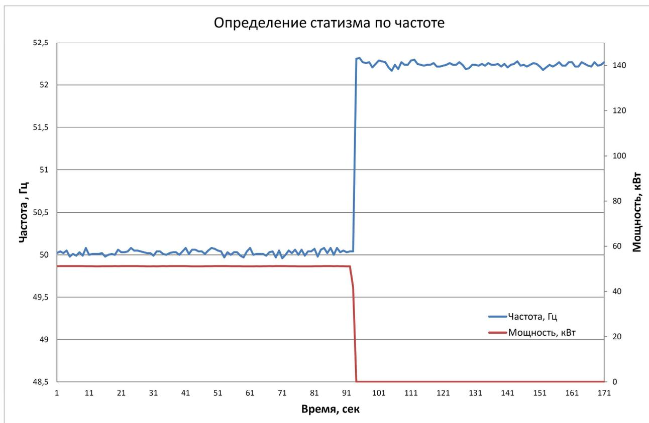
В данном случае имеем:  $f_{i,r} = 52,24$  Гц,  $f_r = 50,0$  Гц, отсюда получаем  $\delta f_{st} = 4,48\%$
