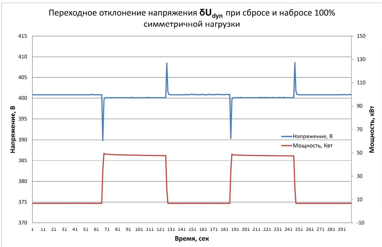
В данном случае мы имеем,  $U_{dyn,min} = 389,8\text{В}$ ,  $U_{dyn,max} = 408,6\text{В}$ ,  $U_r = 400,0\text{ В}$ , отсюда получаем  $\delta U_{dyn}^- = -2,55\%$ ,  $\delta U_{dyn}^+ = +2,15\%$ .
