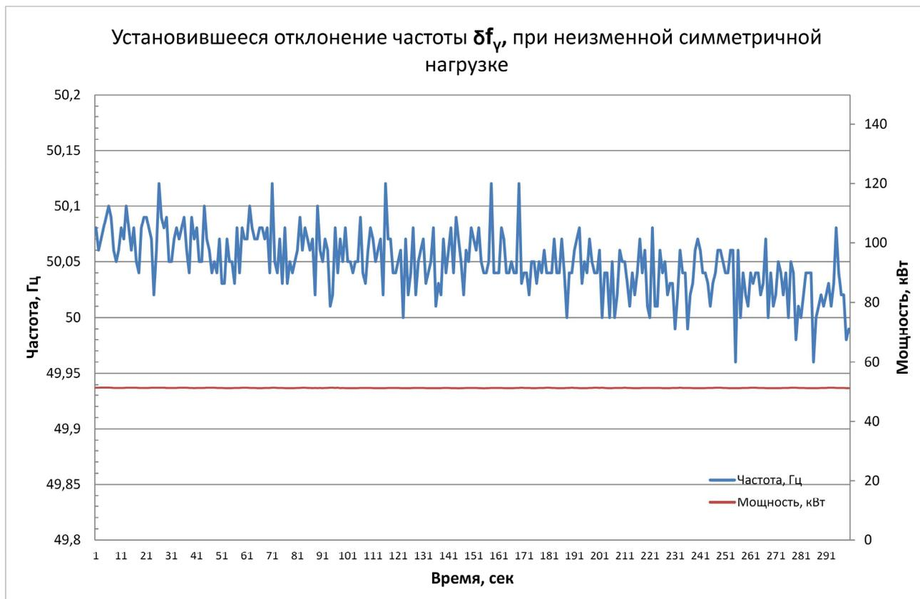
В данном случае мы имеем,  $f_{max} = 50,12$  Гц,  $f_{min} = 49,96$  Гц,  $f_r = 50,0$  Гц, отсюда получаем  $\delta f_y = 0,16\%$ .
