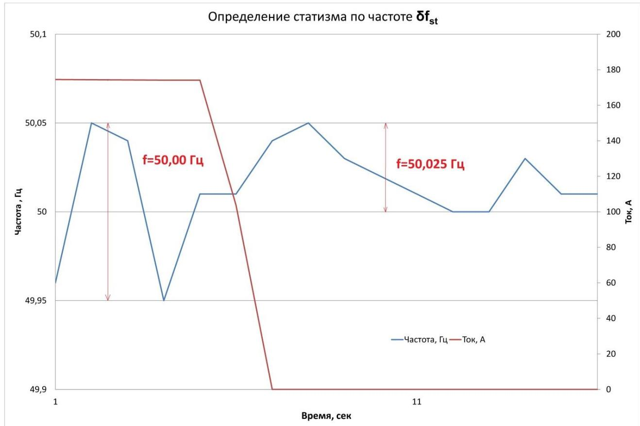
В данном случае имеем:  $f_{i,r} = 50,025 \text{ Гц}$ ,  $f_r = 50,0 \text{ Гц}$ , отсюда получаем  $\delta f_{st} = 0,05\%$
