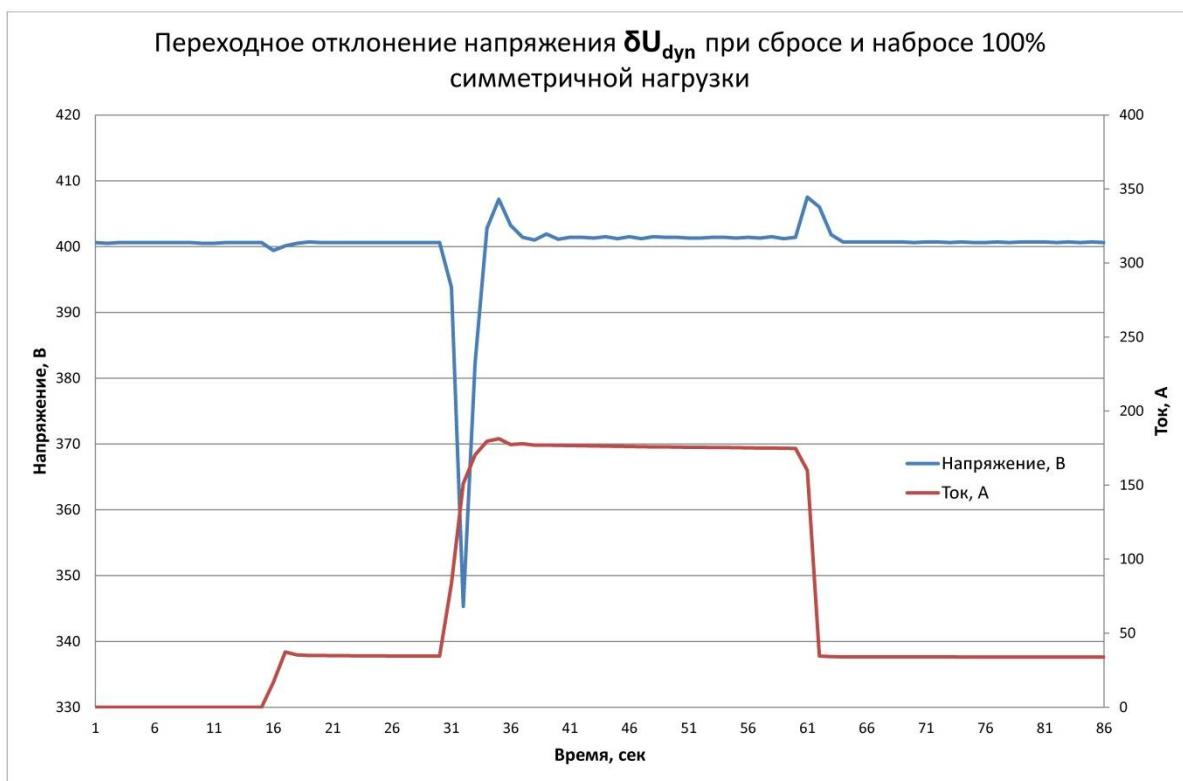
В данном случае мы имеем,  $U_{dyn,min} = 345,3\text{В}$ ,  $U_{dyn,max} = 407,2\text{В}$ ,  $U_r=400,0$  В, отсюда получаем  $\delta U_{dyn}^- = -13,67\%$ ,  $\delta U_{dyn}^+ = 1,8\%$ .
