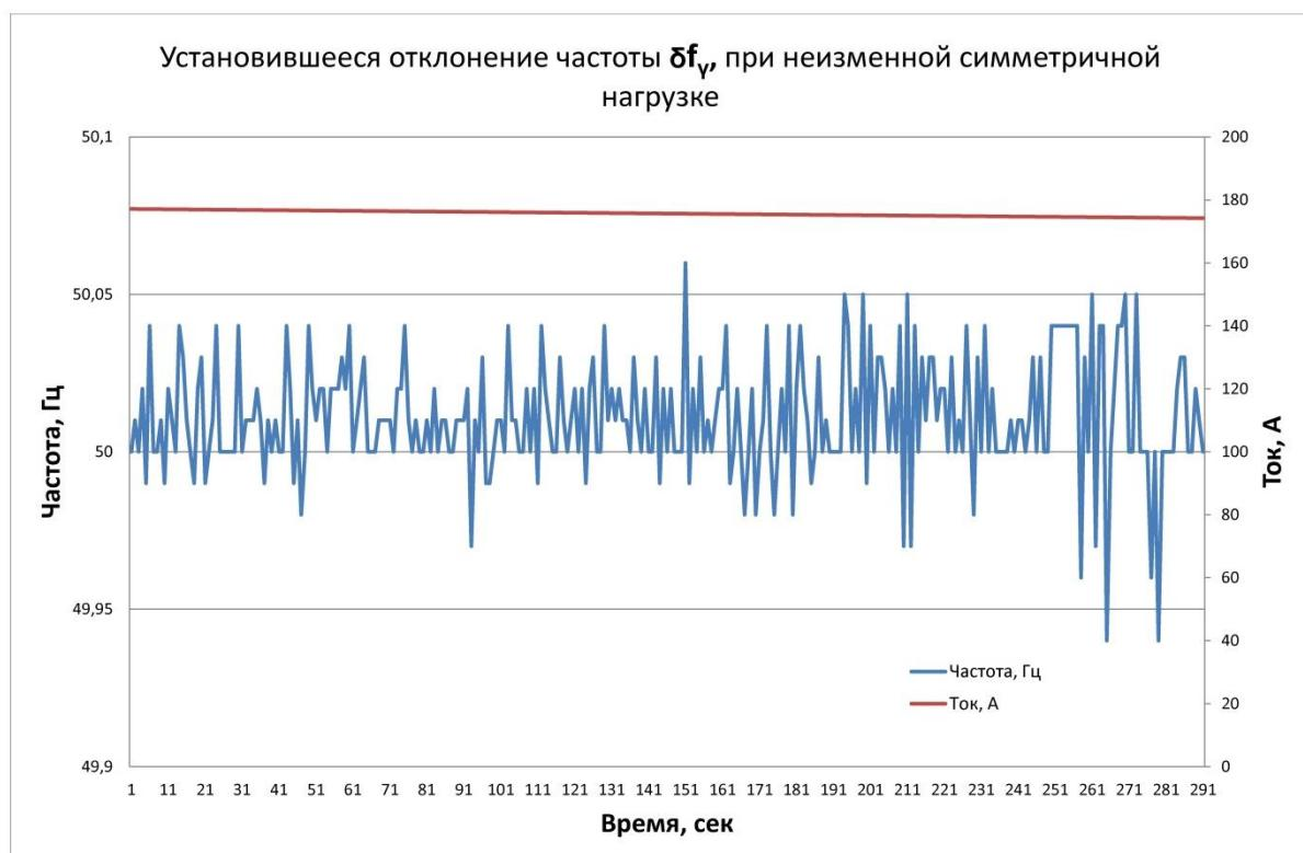
В данном случае мы имеем,  $f_{max} = 50,06$  Гц,  $f_{min} = 49,94$  Гц,  $f_r = 50,0$  Гц, отсюда получаем  $\delta f_y = 0,12\%$ .
