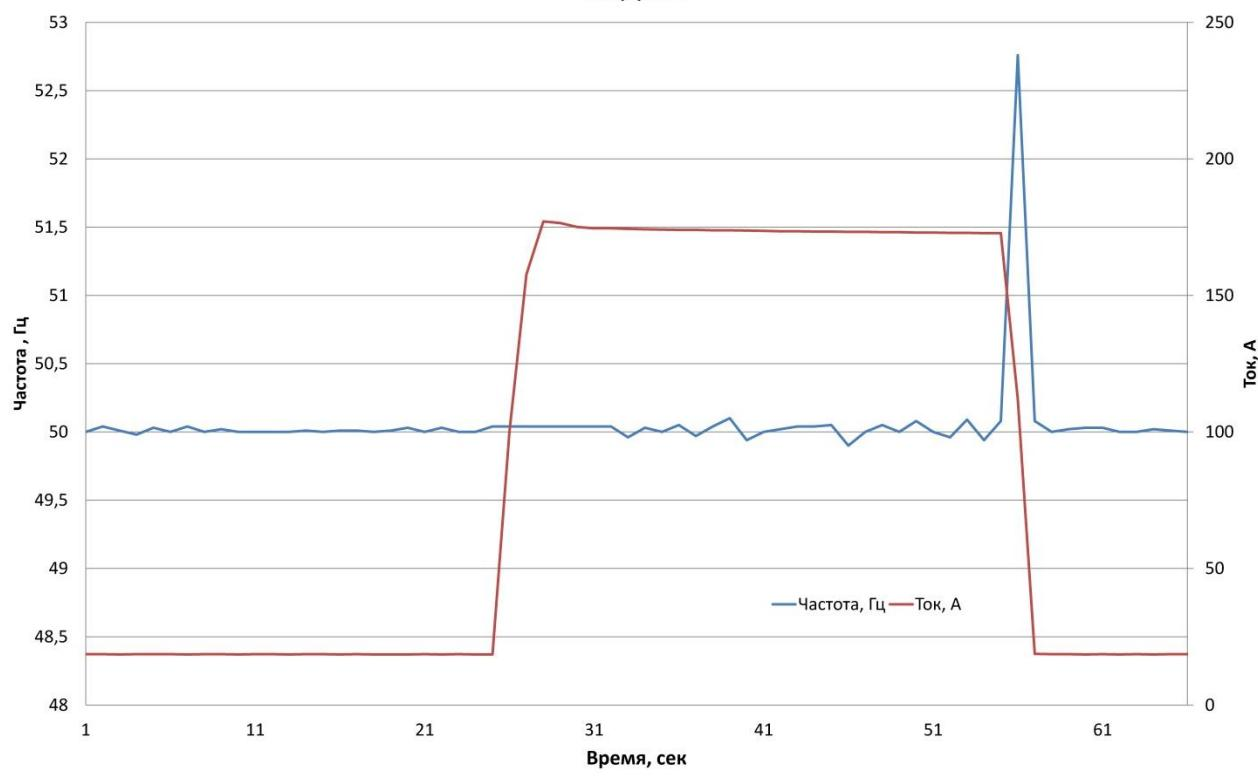
**Пункт 5.** Время восстановления частоты при сбросе/набросе 100% симметричной нагрузки.
