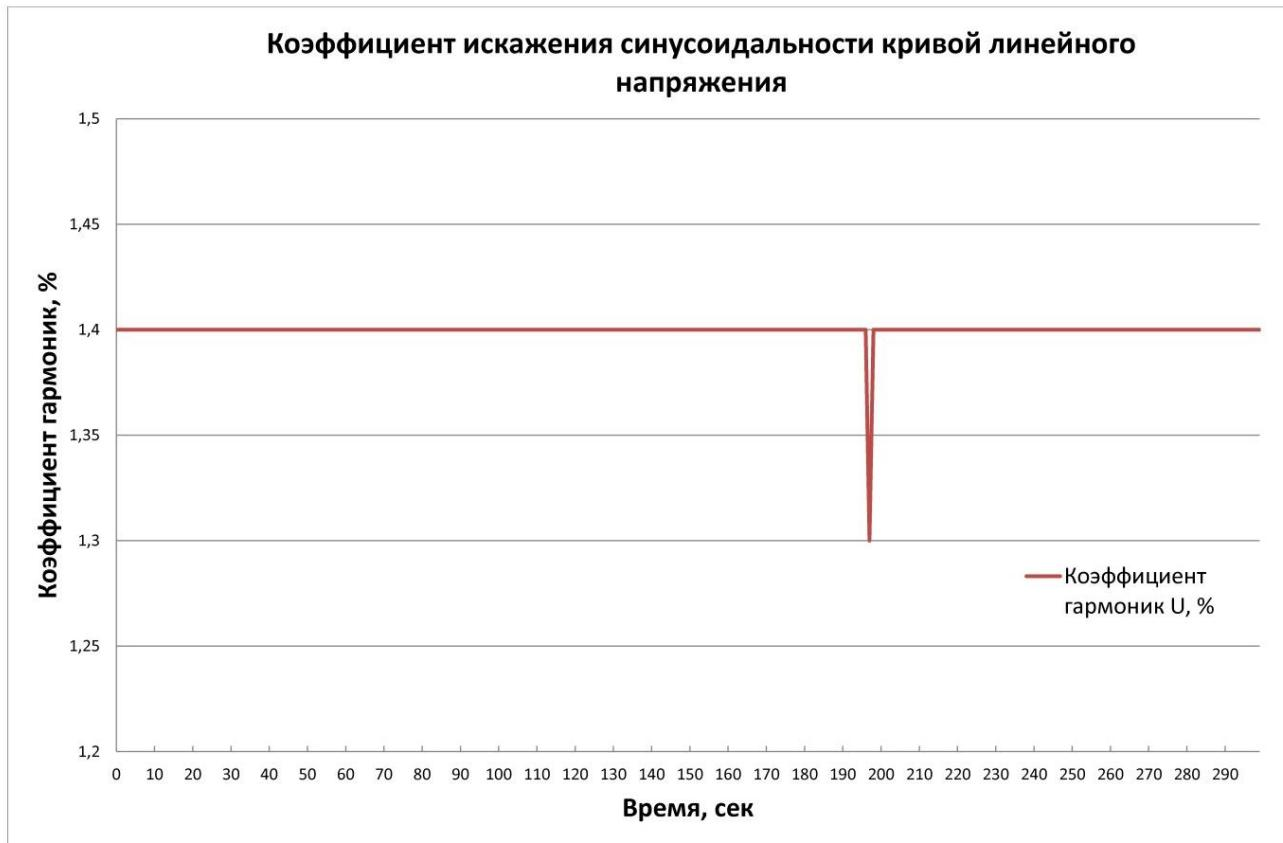
Коэффициент искажения синусоидальности кривой напряжения измеряется в режиме Х.Х. Из приведенного графика имеем  $U_{\text{thd}}=1,4\%$
