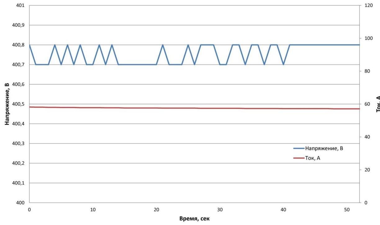
Определение установившегося значения отклонения напряжения при неизменной симметричной нагрузке производят по формуле  $\delta U_y = \frac{U_{max} - U_{min}}{2U_r} * 100$ . В данном случае мы имеем,  $U_{max} = 400,8\text{ В}$ ,  $U_{min} = 400,7\text{ В}$ ,  $U_r = 400,0\text{ В}$ , отсюда получаем  $\delta U_y = 0,01\%$ .
