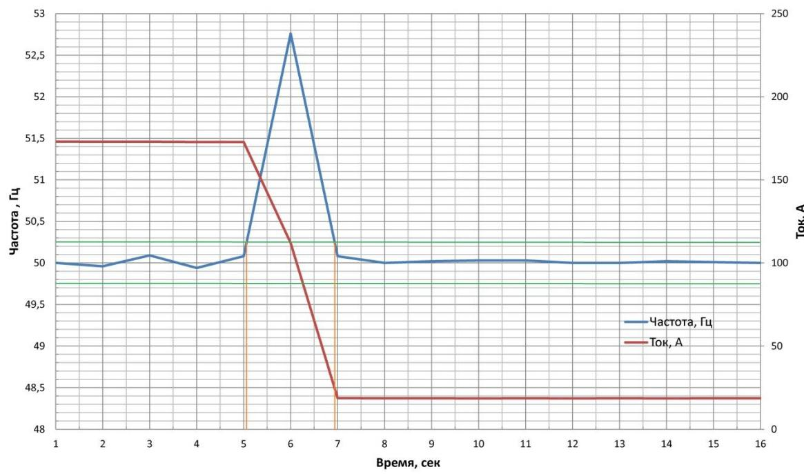
В данном случае имеем: зона допустимых значений установившегося значения частоты ( $\pm 0,5\%$  от  $f_{arb}$ ) равна  $49,77 \div 50,27$  Гц, из осциллографии находим  $t_{восст} = 2,1$  сек.
