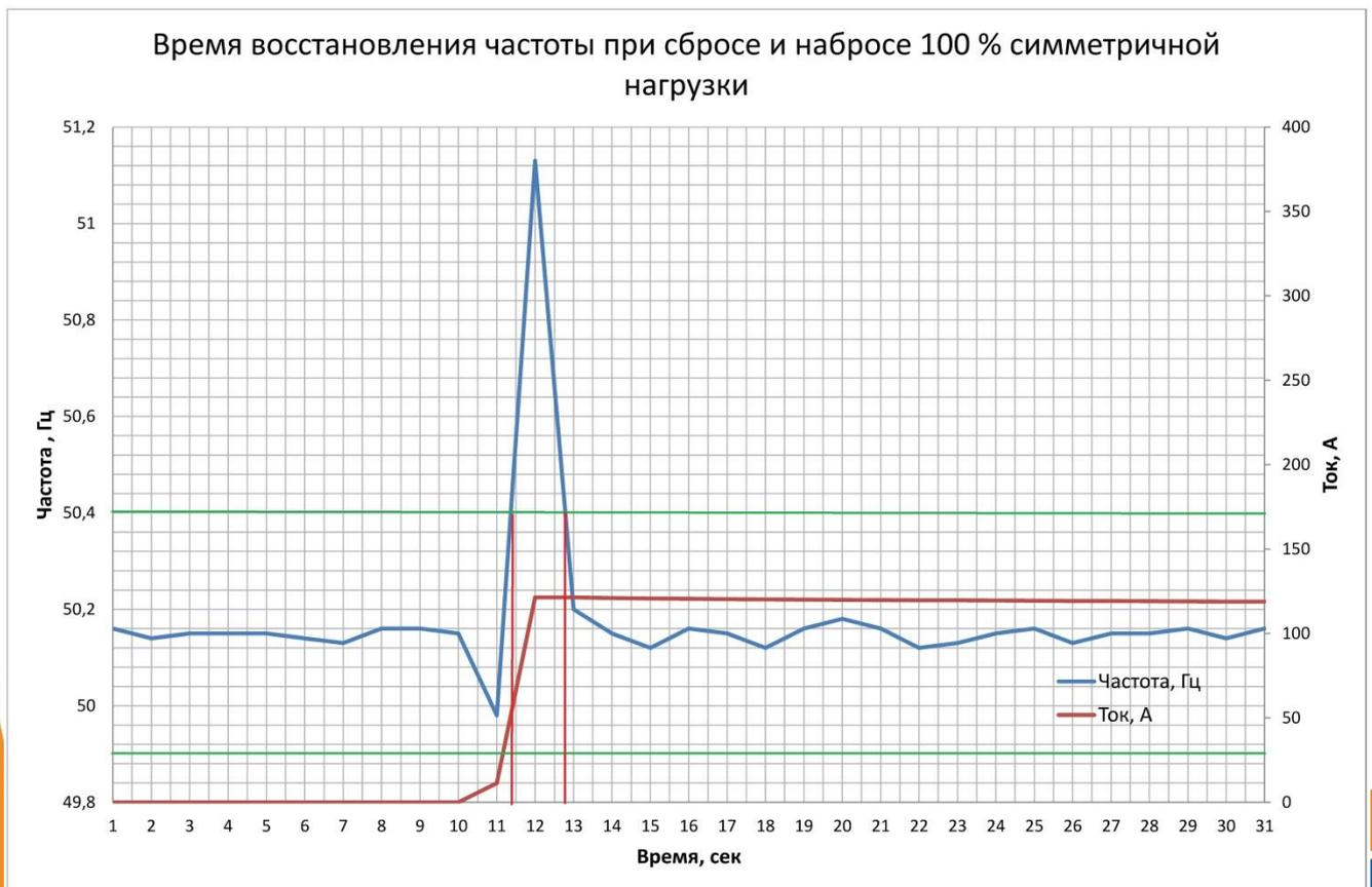
В данном случае имеем: зона допустимых значений установившегося значения частоты ( $\pm 0,5\%$  от  $f_{arb}$ ) равна  $49,9 \div 50,4$  Гц, из графика находим  $t_{восст} = 1,3$  сек.
