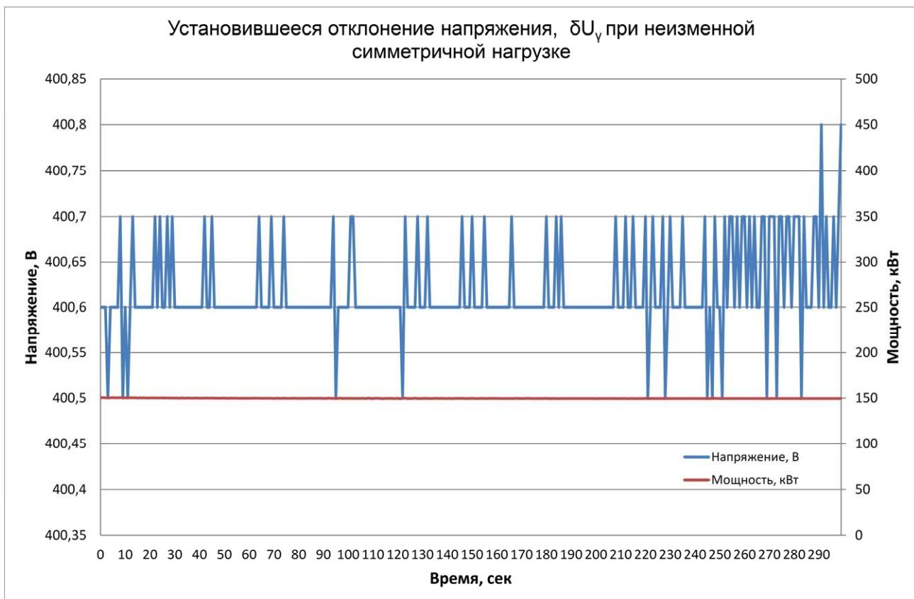
В данном случае мы имеем,  $U_{max} = 400,8$  В,  $U_{min} = 400,5$  В,  $U_r = 400,0$  В, отсюда получаем  $\delta U_y = 0,04\%$ .
