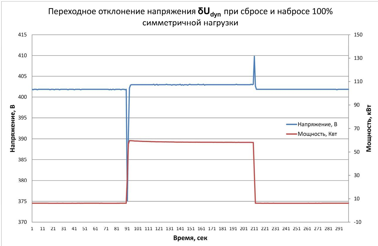
В данном случае мы имеем,  $U_{dyn,min} = 375,1\text{В}$ ,  $U_{dyn,max} = 409,8\text{В}$ ,  $U_r=400,0\text{ В}$ , отсюда получаем  $\delta U_{dyn}^- = -6,23\%$ ,  $\delta U_{dyn}^+ = +2,45\%$ .
