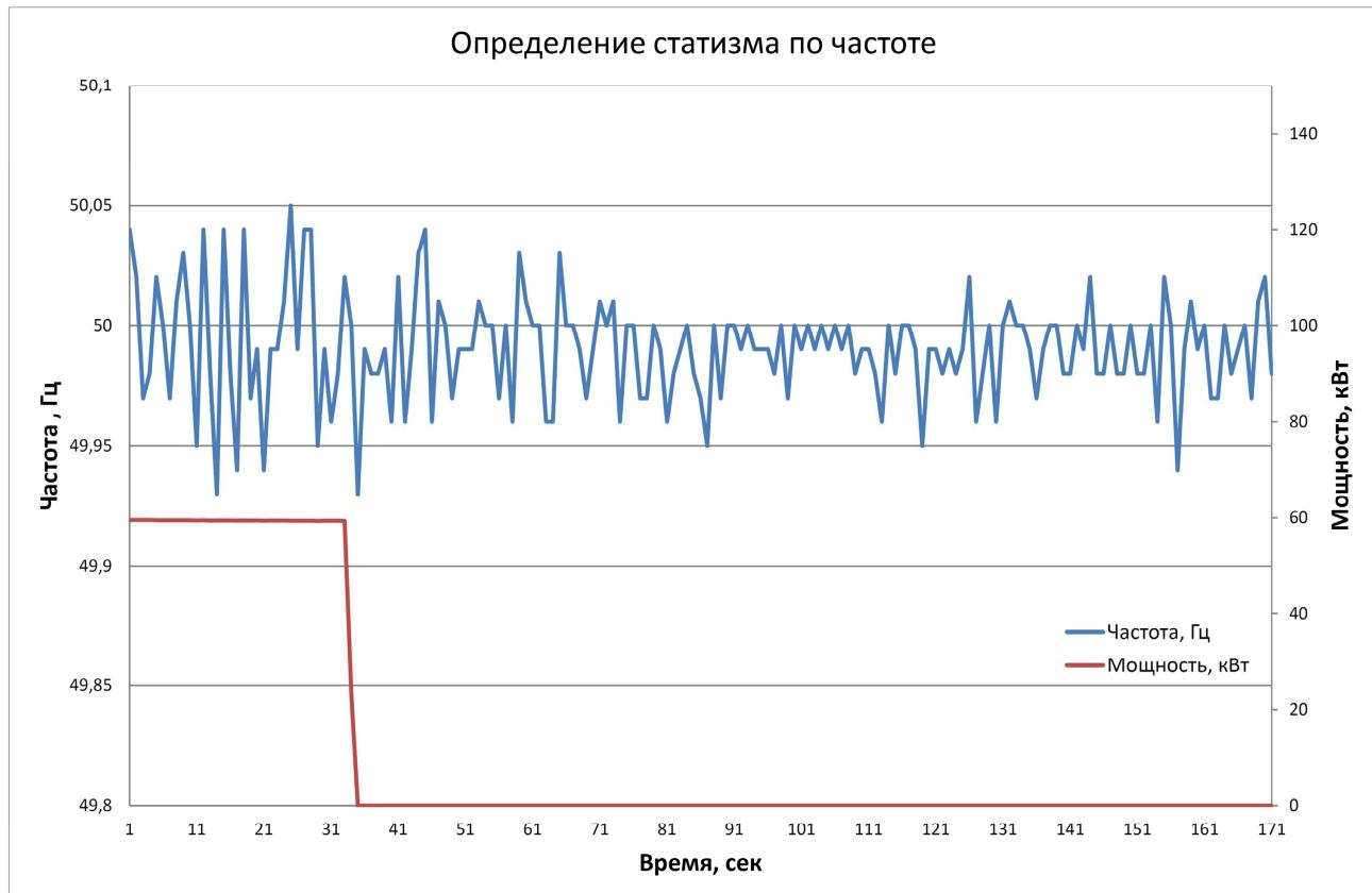
В данном случае имеем:  $f_{i,r} = 50,02 \text{ Гц}$ ,  $f_r = 50,0 \text{ Гц}$ , отсюда получаем  $\delta f_{st} = 0,04\%$
