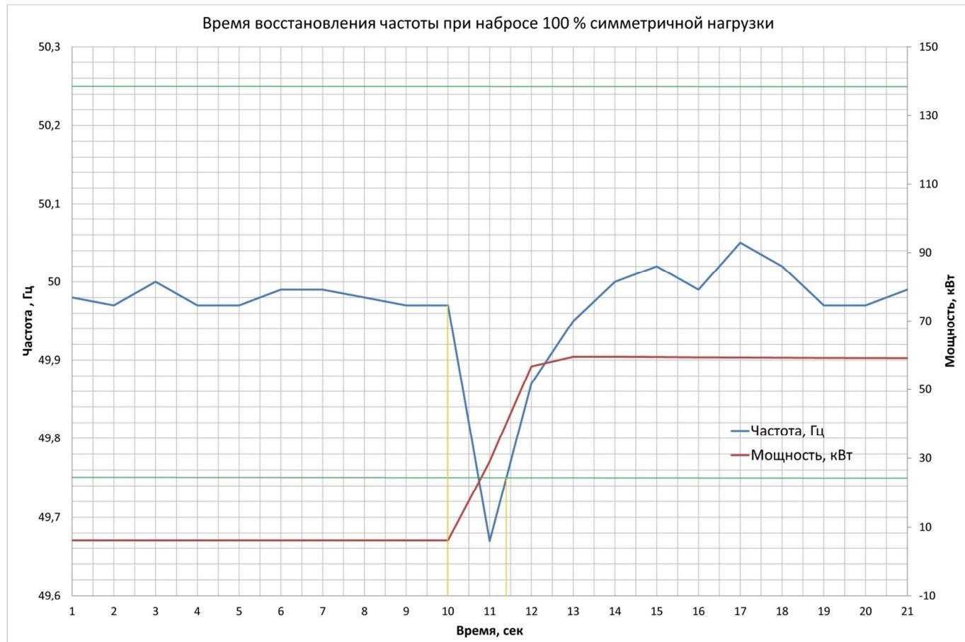
В данном случае имеем: зона допустимых значений установившегося значения частоты  $\pm 0,5\%$  от частоты фактической мощности  $f_{arb}=50,0$  равна  $49,75 \div 50,25$  Гц, из графика находим  $t_{f,in} = 1,4$  сек.
