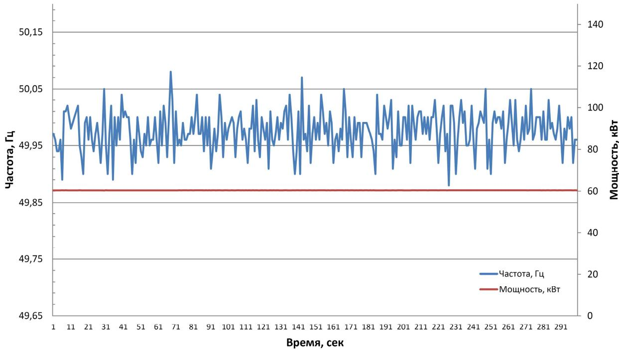
В данном случае мы имеем,  $f_{max} = 50,08$  Гц,  $f_{min} = 49,88$  Гц,  $f_r = 50,0$  Гц, отсюда получаем  $\delta f_y = 0,2\%$ .
