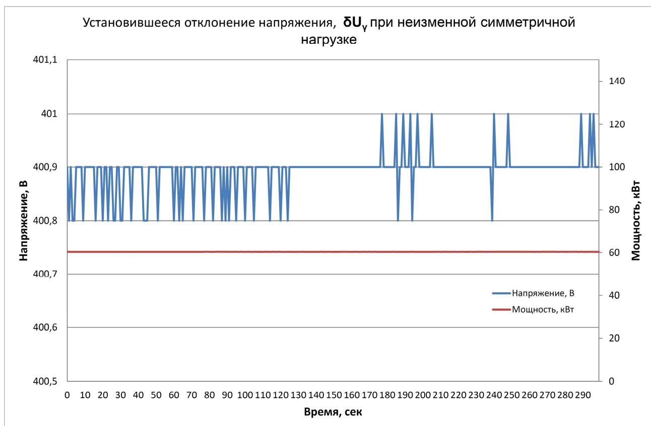
В данном случае мы имеем,  $U_{max} = 401,0$  В,  $U_{min} = 400,8$  В,  $U_r = 400,0$  В, отсюда получаем  $\delta U_y = 0,025\%$ .
