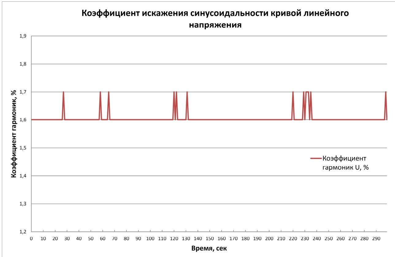
Коэффициент искажения синусоидальности кривой напряжения измеряется в режиме Х.Х. Из приведенного графика имеем  $U_{\text{thd}}=1,7\%$ .
