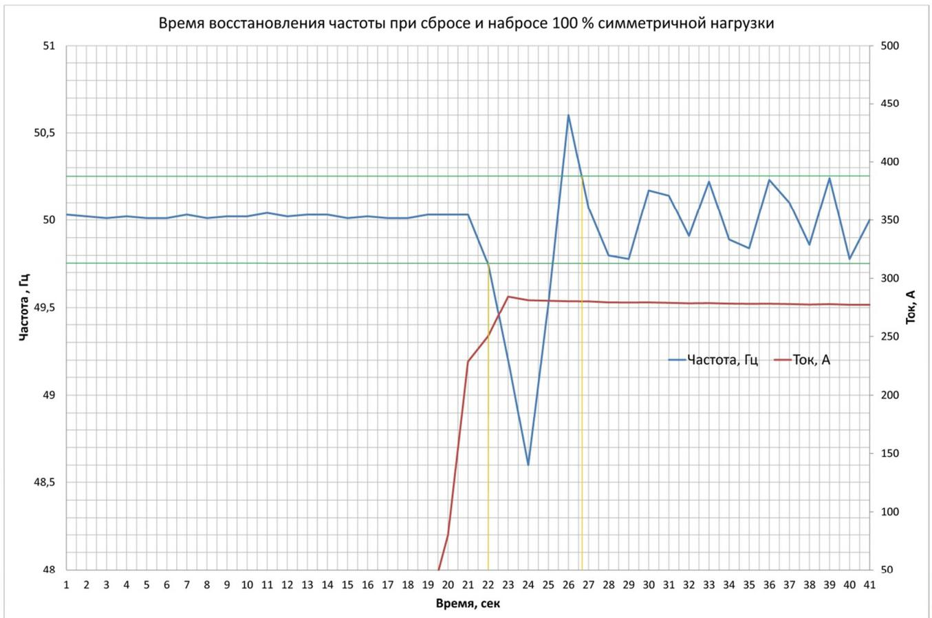
В данном случае имеем: зона допустимых значений установившегося значения частоты ( $\pm 0,5\%$  от  $f_{arb}$ ) равна  $49,75 \div 50,25$  Гц, из графика находим  $t_{восст} = 4,6$  сек.
