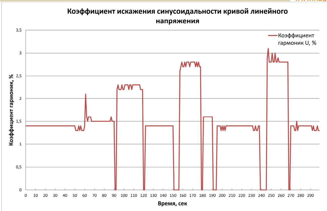
Коэффициент искажения синусоидальности кривой напряжения измеряется в режиме Х.Х. Из приведенного графика имеем  $U_{thd}=1,4\%$  (первые 50 секунд).
