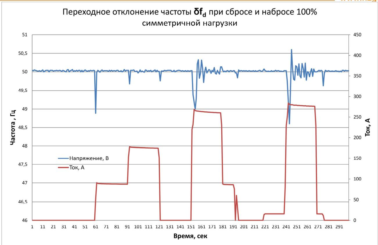
**Пункт 5.** Время восстановления частоты при сбросе/набросе 100% симметричной нагрузки.
