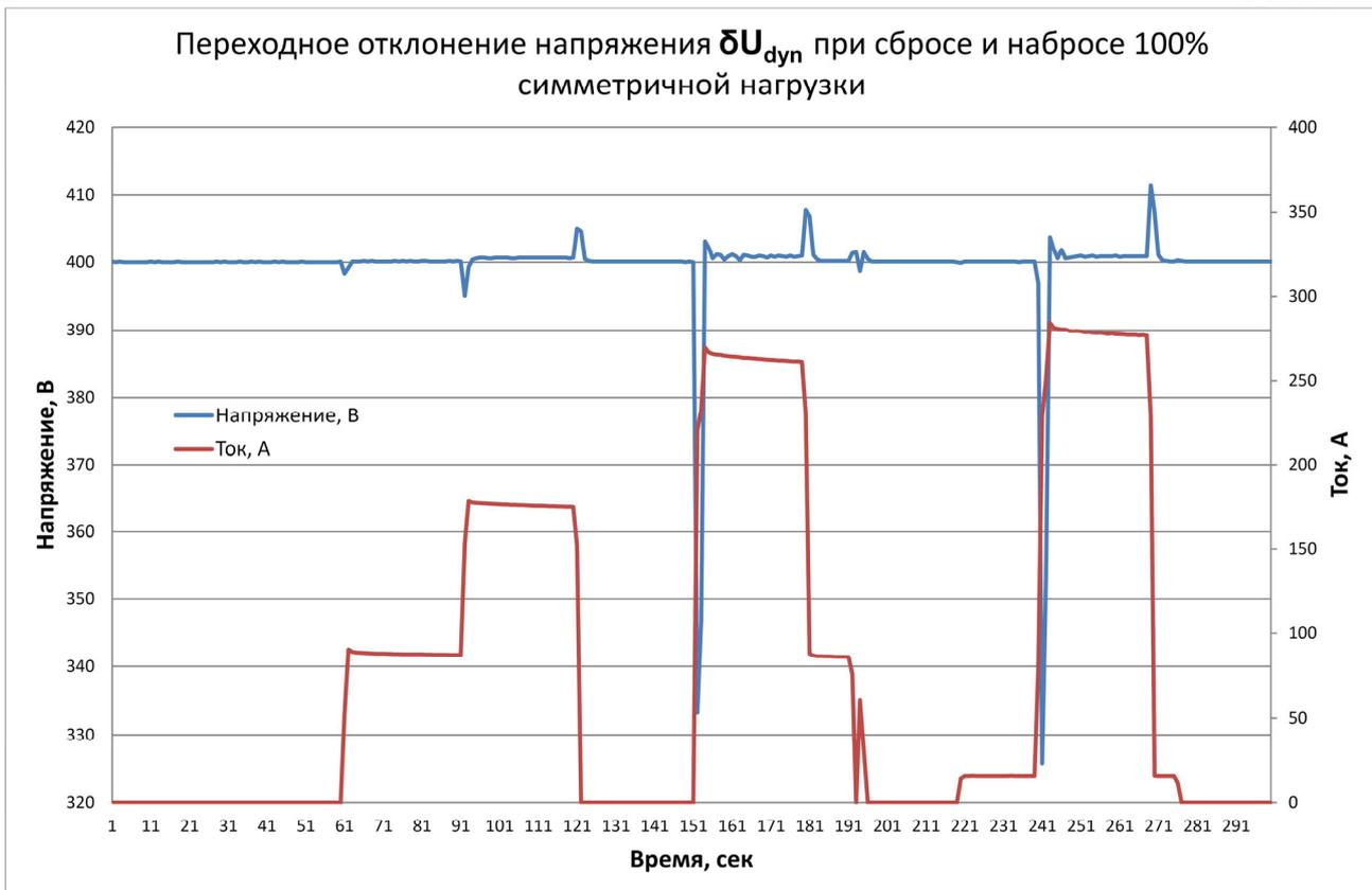
В данном случае мы имеем,  $U_{dyn,min} = 325,7В$ ,  $U_{dyn,max} = 411,4В$ ,  $U_r = 400,0 В$ , отсюда получаем  $\delta U_{dyn}^- = -18,58\%$ ,  $\delta U_{dyn}^+ = 2,85\%$ .
