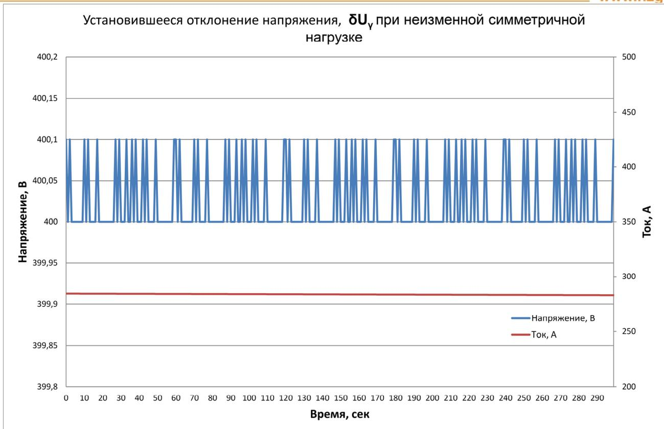
В данном случае мы имеем,  $U_{max} = 400,1\text{В}$ ,  $U_{min} = 400,0\text{В}$ ,  $U_r = 400,0\text{ В}$ , отсюда получаем  $\delta U_y = 0,013\%$ .
