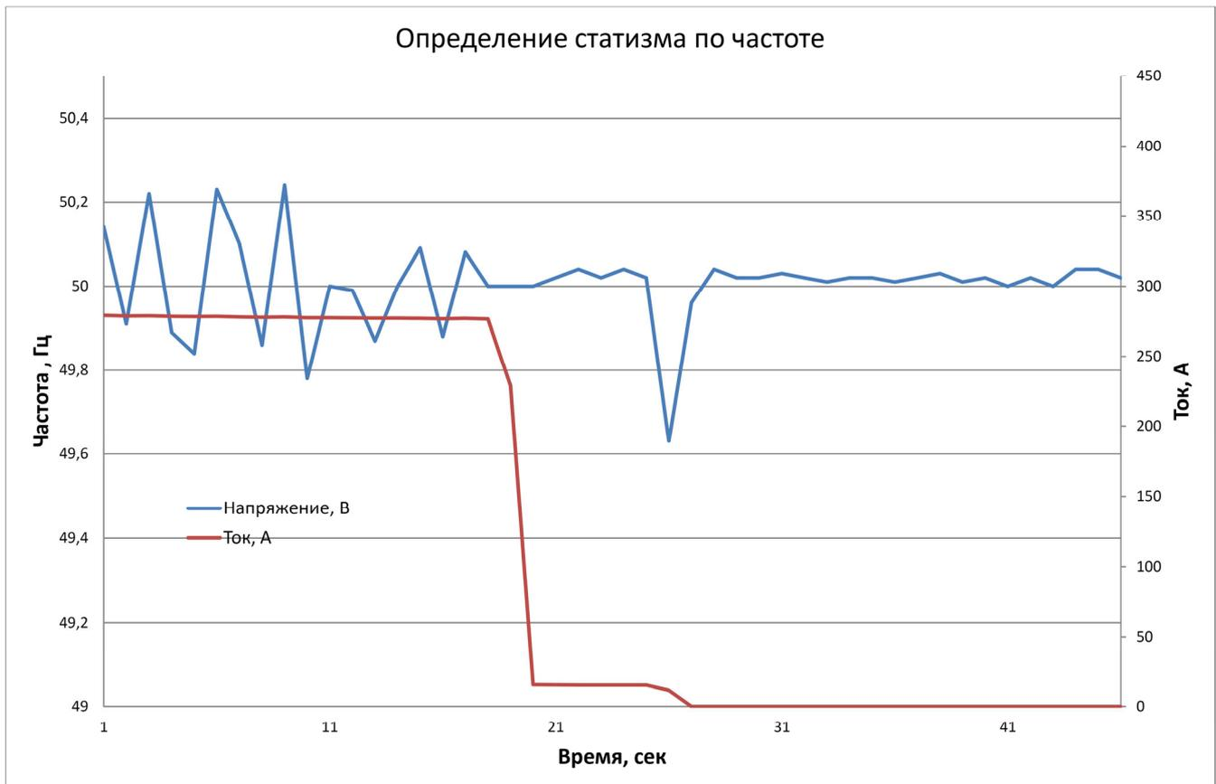
В данном случае имеем:  $f_{i,r} = 50,04$  Гц,  $f_r = 50,24$  Гц, отсюда получаем  $\delta f_{st} = 0,39\%$
