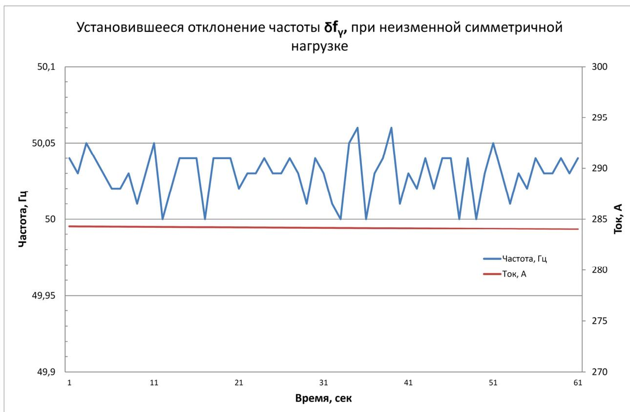
В данном случае мы имеем,  $f_{max} = 50,06$  Гц,  $f_{min} = 50,00$  Гц,  $f_r = 50,0$  Гц, отсюда получаем  $\delta f_y = 0,06\%$ .
